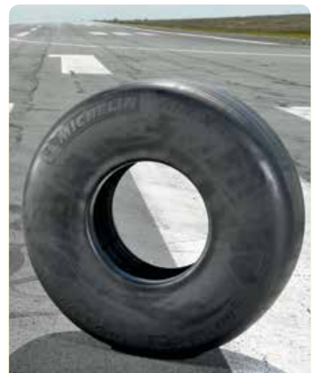
El último neumático radial de tecnología NZG para el Airbus A 350 Peso 126,5 Kg y altura 1,32 m
